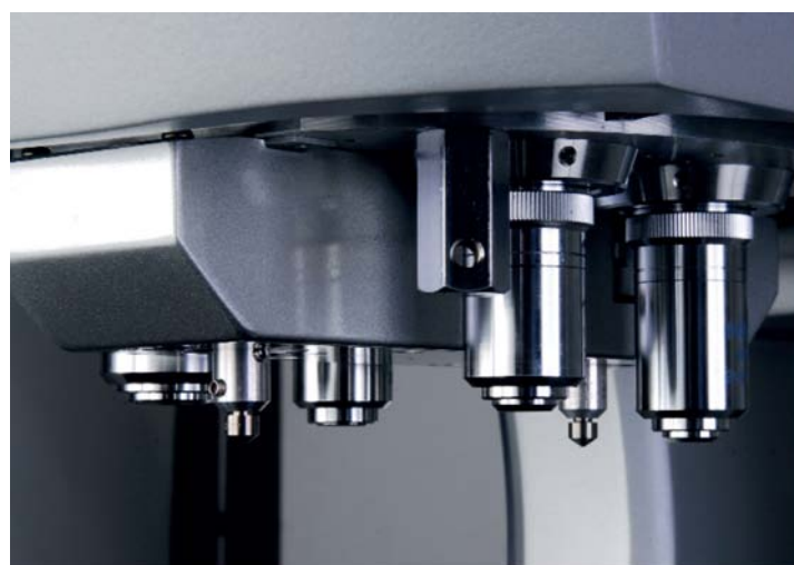
Figura 2: Turelă cu până la două indentoare și patru lentile
