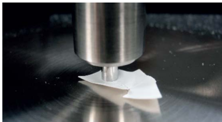
Figura 1: Pansonul de presiune al DuraSAMPLIR apasă o bucată din punga de plastic dezintegrată pe prisma de diamant
