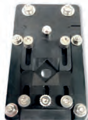
Figura 1: Stativ pentru microprobe pentru probe cu un diametru intern de 10-14 mm sau pentru probe de formă rectangulară; diametrul maxim al fasciculului de lumină pentru măsurarea transmitanței este de 5 mm
