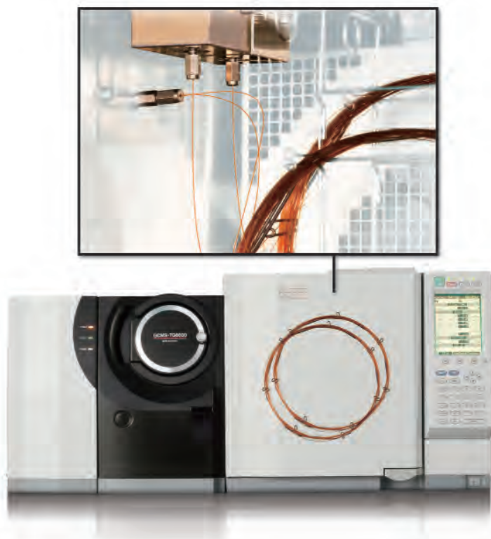
Figura 4: Configurația cu două linii a sistemului GCMS-TQ8030
