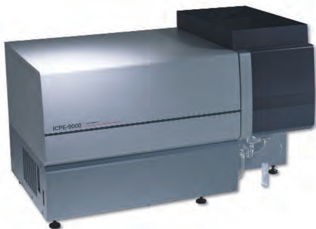
Figura 1: ICPE-9000, un spectrometru ICP-OES cu observare duală
