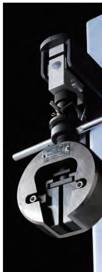
Figura 2: Sistem de imobilizare anti-rotire autoblocant cu celulă de încărcare de înaltă precizie
