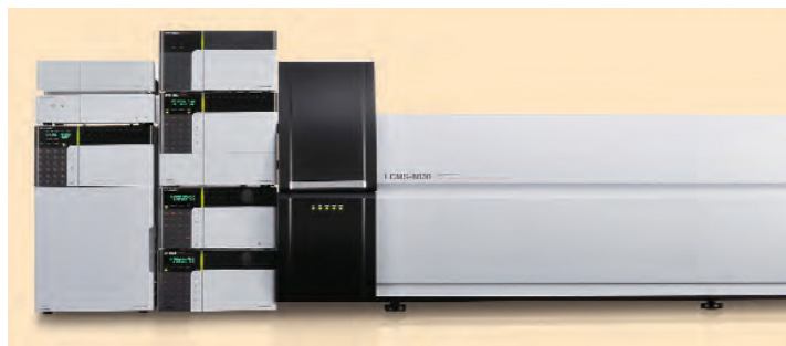
Figura 3: Sistemul LCMS-8030 este unul dintre cele mai rapide sisteme de pe piață, cu un timp de schimbare a polarității de doar 15 msec, o viteză de scanare de 15.000 u/sec și timpi de așteptare de 1 msec
