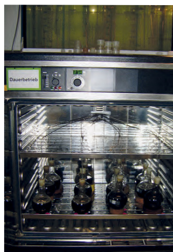
Figura 1: Instalație experimentală pentru producerea de biogaz în laborator
