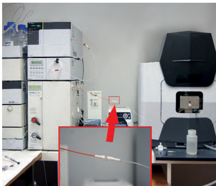
Figura 1: Sistemul de analiză HPLC-FAAS utilizat în laboratorul Departamentului de analiză a apei și solurilor, Facultatea de Chimie, Universitatea Adam Mickiewicz, Poznań, Polonia
