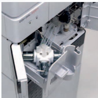
Figura 1: Pompa Nexera având instalată o valvă de gradient cuaternar
