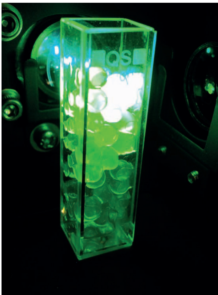
Figura 1: Sfere cu aspect de caviar, pe bază de alginat preparat cu fluoresceină, la o lungime de undă de excitație de 460 nm. Aparatul utilizat este un spectrofotometru cu fluorescență Shimadzu RF-5301PC. Produsul obținut este un pseudocaviar fluorescent introdus într-o celulă de cuarț de 1 cm.
